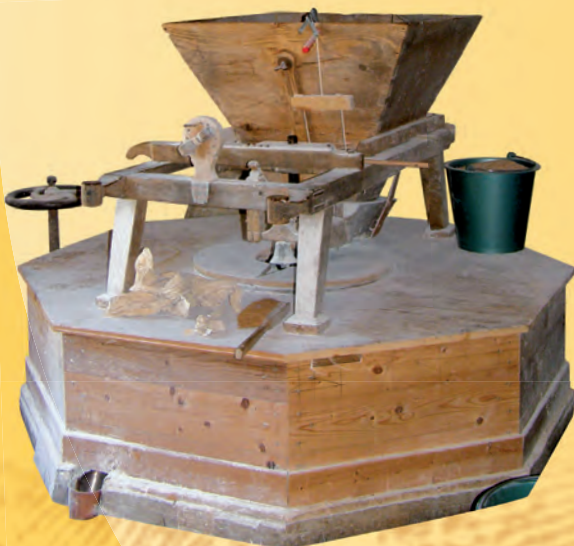
▲ Trémie et meules du moulin de Baissey (42)
