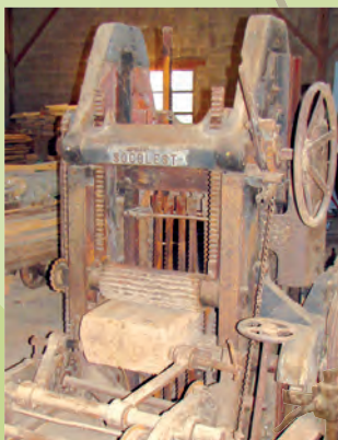
▲ Scie multiple à la scierie parqueterie de Tavongoutte aux Rouges-Eaux (88)
