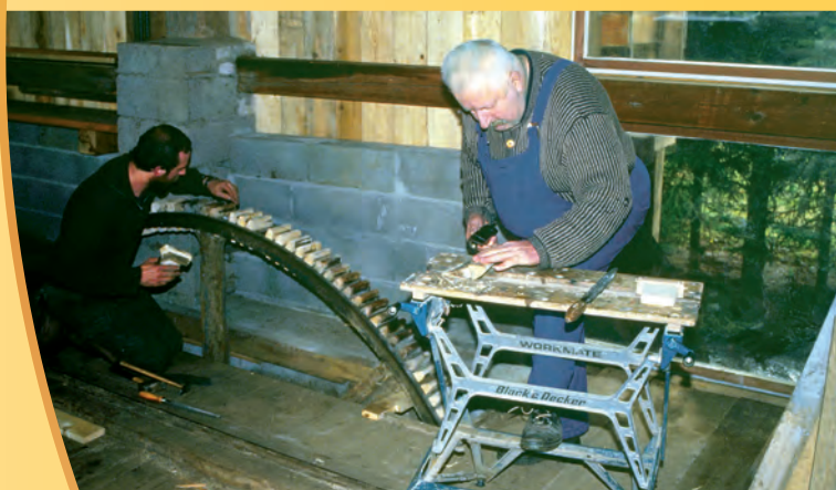
▲ Remplacement et ajustage des 128 dents de la grosse roue dentée.
