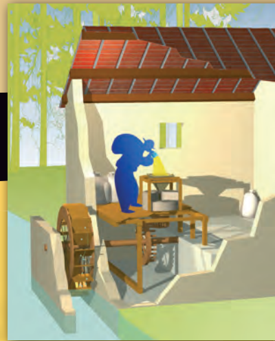
▲ Schéma d'un moulin à blé du 18 e siècle © Région Poitou-Charente, Inventaire Général Dessin : Zoé Lambert, 2007
