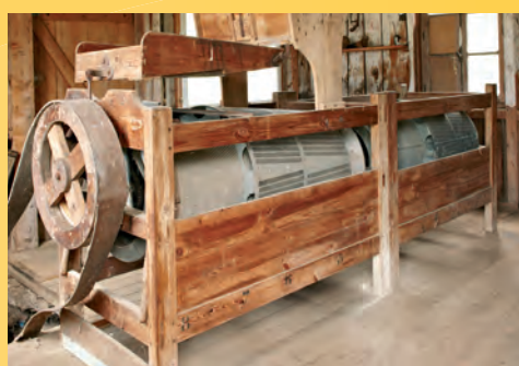
▲ Remise : trieur à céréales installé en 1928.
