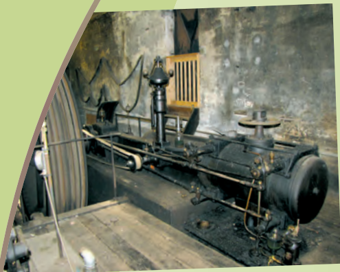
▲ Machine à vapeur de type Farcot-Corliss à la scierie Vincent de Sainte-Croix-aux-Mines (68)
